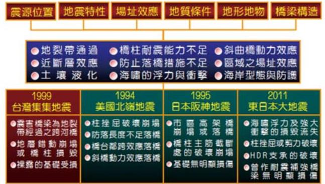
圖 11 橋梁地震災害的成因與破壞模式
