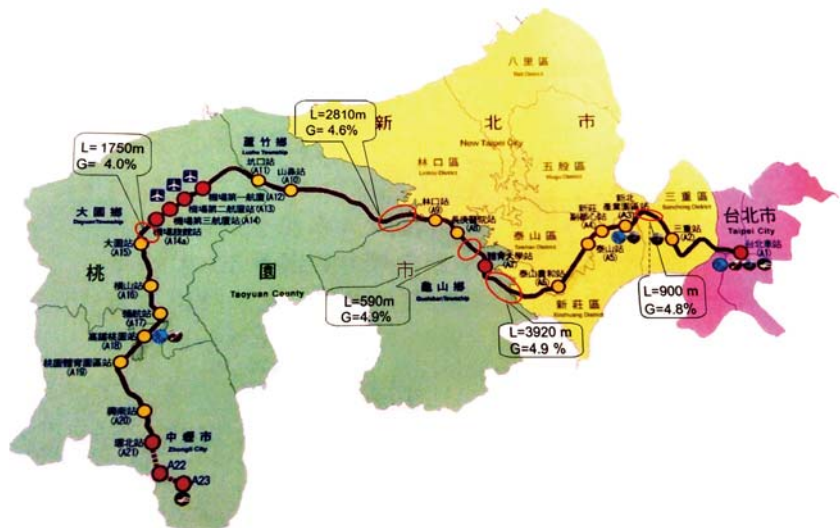
圖 3 機場捷運陡坡區段位置示意圖
