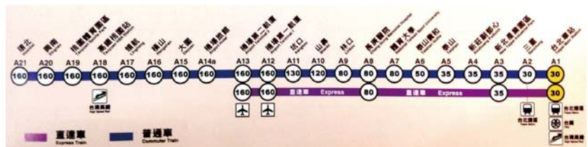
圖 2 機場捷運直達車與普通車混合運轉
