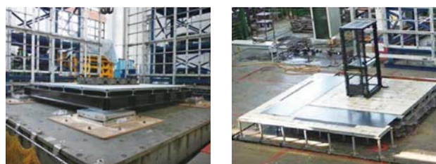
圖 17 資訊機房隔震高架地板系統試驗
