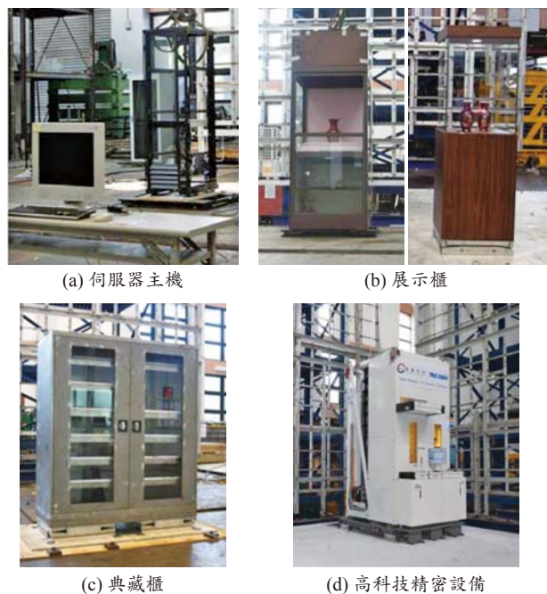
圖 15 單櫃隔震試驗
