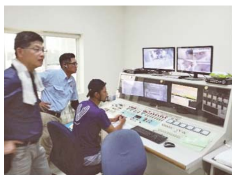
(a) 預拌廠內以電腦控制拌合流程
