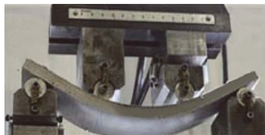
圖1 高性能纖維混凝土彎曲變形能力 [10]
