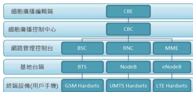
圖 4 細胞廣播服務網絡架構示意圖
