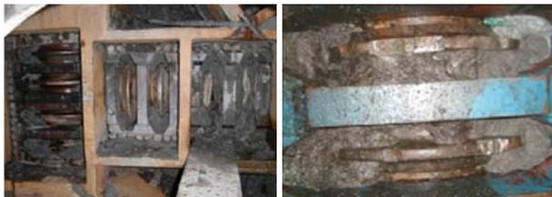
圖 1 切刃面盤遭黏土包覆之情形與包泥造成切刃磨損 (廖銘洋<sup>[4]</sup>)
