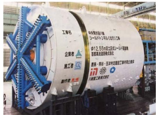
圖 13 首都高速道路中央環狀線 (品川線)  $\phi$ 12.55 m
