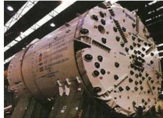
圖 31 雪山隧道主坑與導坑雙盾式 TBM
