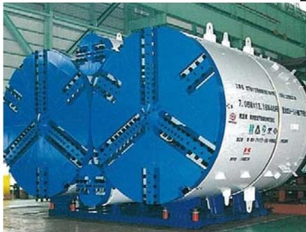
圖 19 4 心圓 TBM 施築車站
