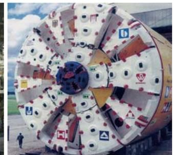
圖 12 第 4 艾爾貝河 (Elb) 隧道  $\phi 14.2$  m
