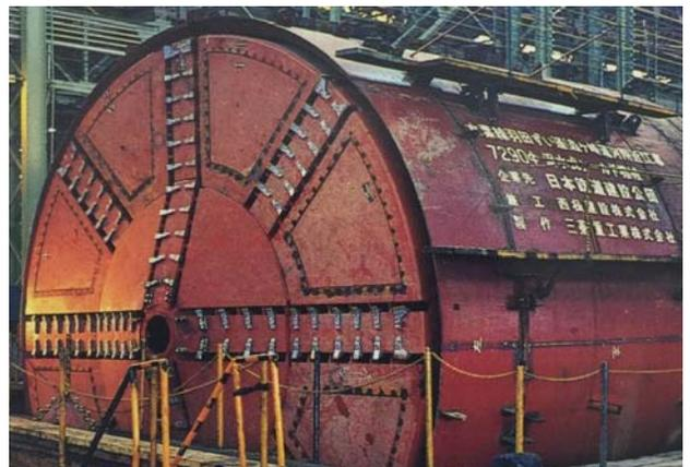
圖 7 世界首例泥水式潛盾機（羽田隧道）
