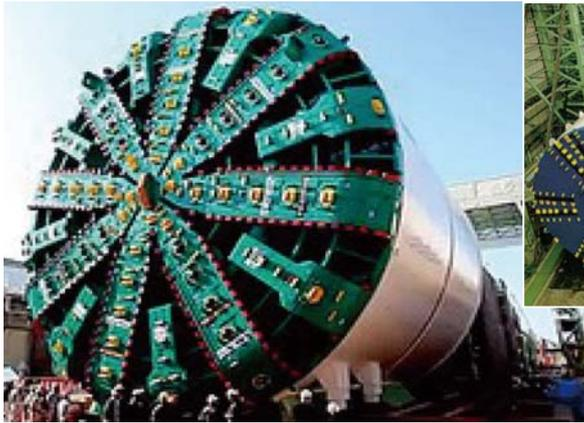
圖 17 美國西雅圖  $\phi 17.45$  m EPB TBM
