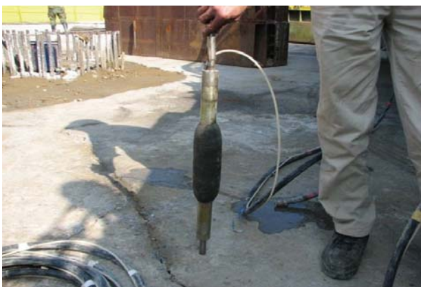
圖 9 單環塞封隔器（膨脹後）
