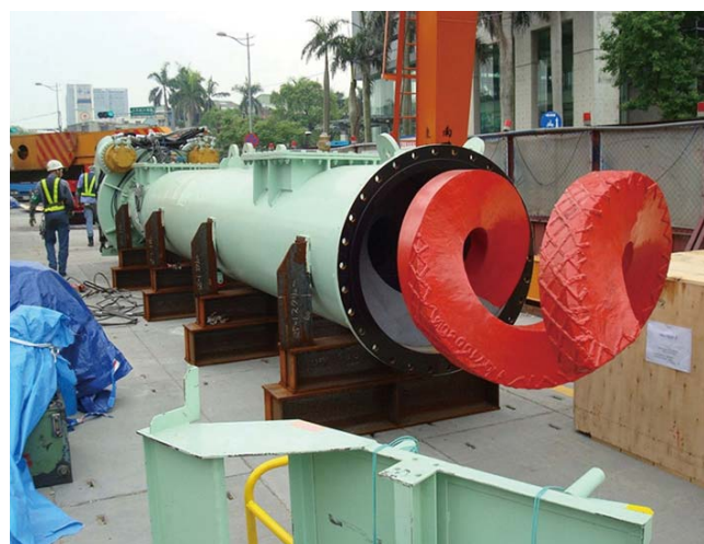
圖 5 無軸式螺運機
