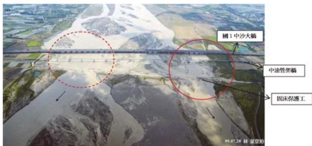
圖 3 中沙大橋上游及兩岸高灘地沖刷狀況（資料來源：國道高速公路局中工處斗南工務段）
