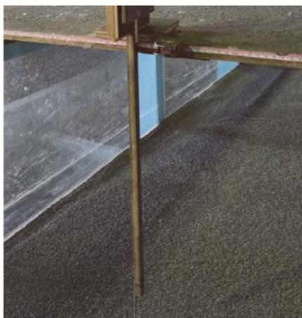
圖 10 垂直式標尺量測設備
