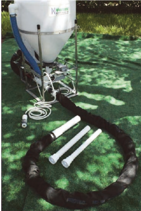
圖 2 Menzie et al. [24] 進行噴灑式薄層覆蓋工法之設備 (Vortex TR Aquatic system)
