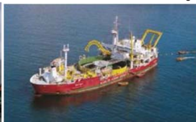
離岸風力機基礎安裝完成，緊接進行鋪纜作業，藉鋪纜船達成。 R&D Center 24
