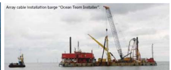
離岸風力機基礎安裝完成，緊接進行鋪纜作業，藉鋪纜船達成。 R&D Center 24
