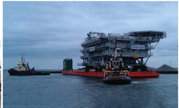
變電站上構大都以千噸級論，陸上很難找到匹配的重件吊車，通常採SPMT出廠及登船。
