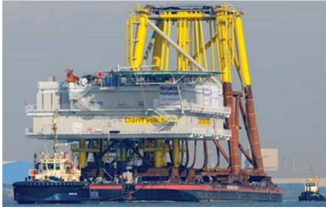
海運後以吊車船吊裝Jacket基礎及Topside。
