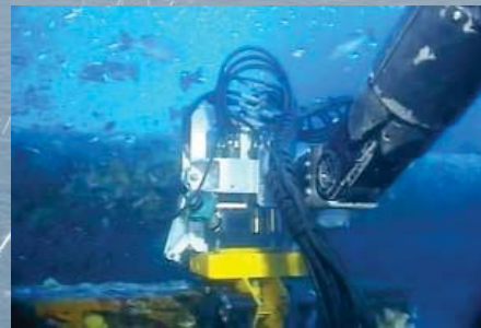
ROV檢測陽極塊使用狀況
