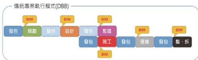
圖 2 DBB 模式下導入 BIM 之時機
