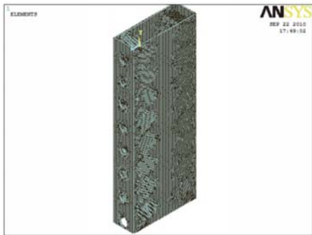
圖 9 鋼殼完全剛接之有限元素
