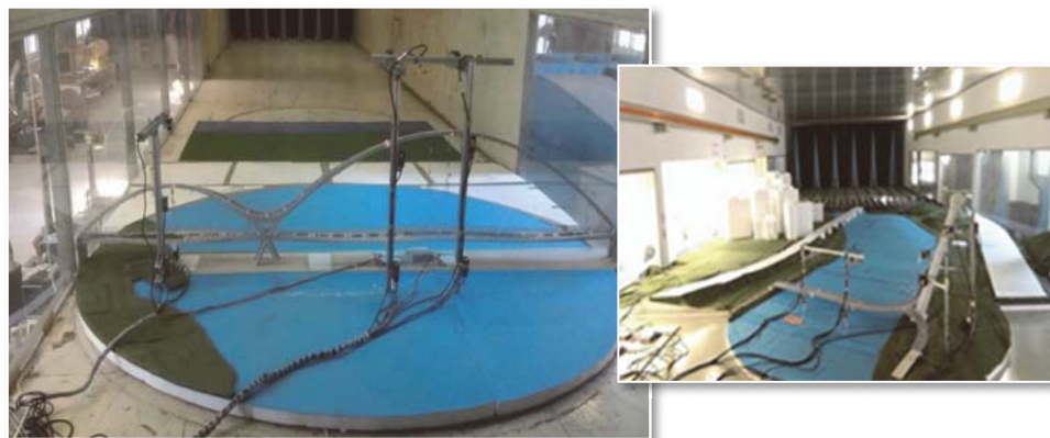
圖 13 風洞模型於紊流邊界層流場之架設
