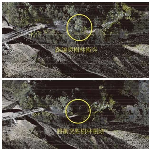
圖 9 點雲圖配合完工狀態刪除不必要點
