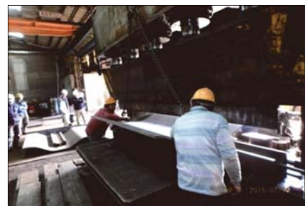
圖 29 本工程採用冷彎加工機具
