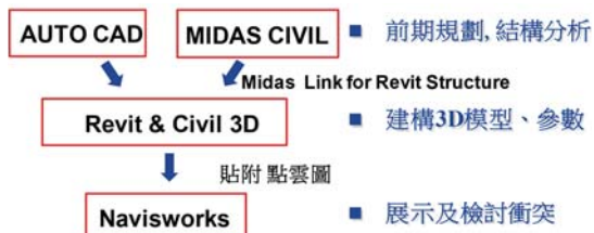
圖 2 BIM 模型建立流程示意圖
