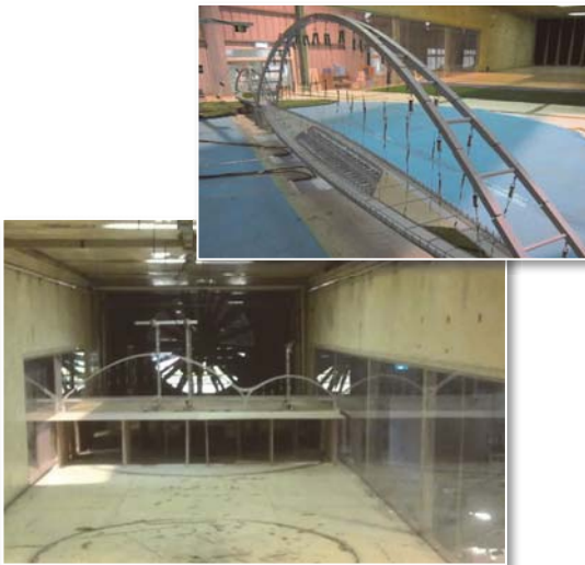
圖 11 大漢溪新月橋風洞試驗模型
