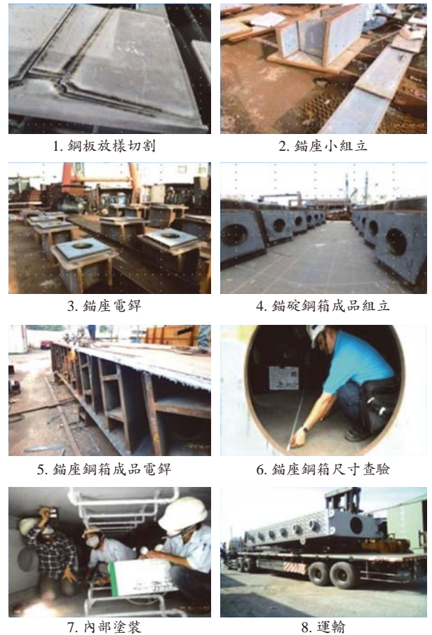
圖 36 錨碇鋼箱產製流程
