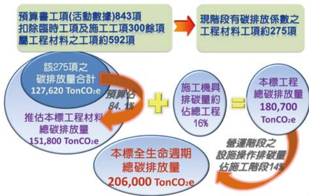
圖 6 C2 標細設推估計算流程圖
