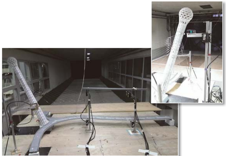
圖 12 基隆河星光橋風洞試驗模型
