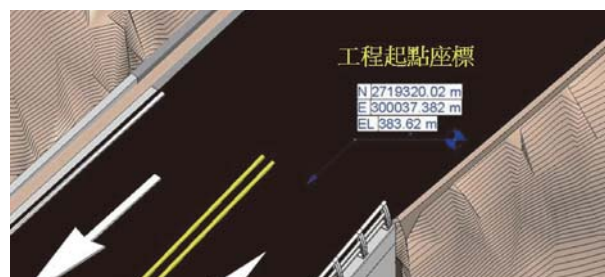
圖 4 BIM 模型符合大地座標
