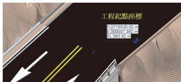
圖 4 BIM 模型符合大地座標
