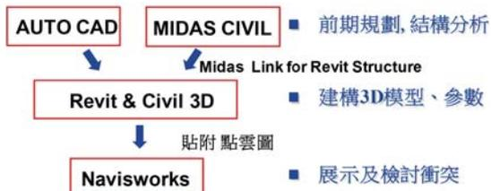
圖 2 BIM 模型建立流程示意圖
