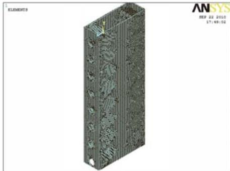
圖 9 鋼殼完全剛接之有限元素
