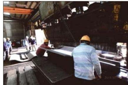
圖 29 本工程採用冷彎加工機具
