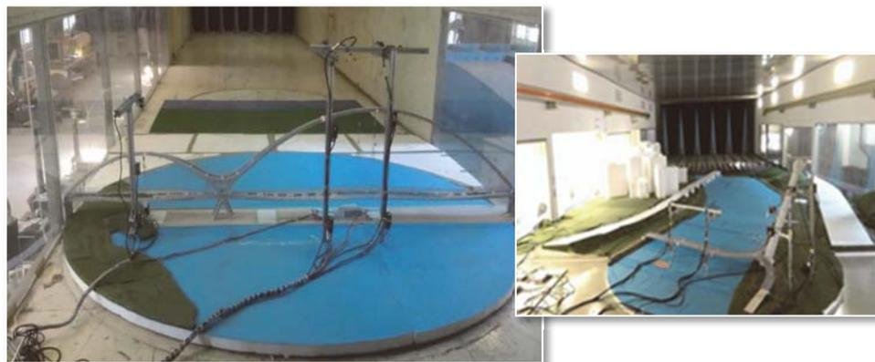
圖 13 風洞模型於紊流邊界層流場之架設
