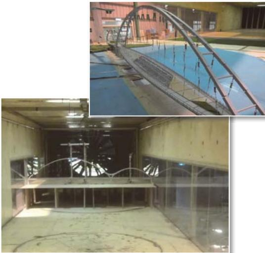
圖 11 大漢溪新月橋風洞試驗模型
