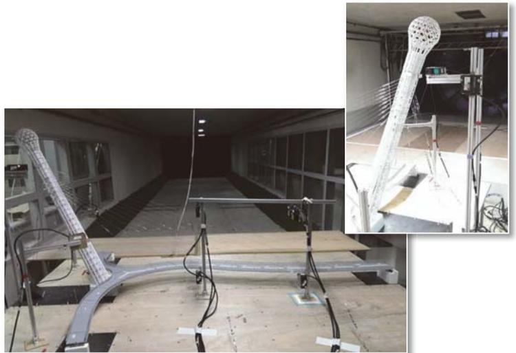
圖 12 基隆河星光橋風洞試驗模型
