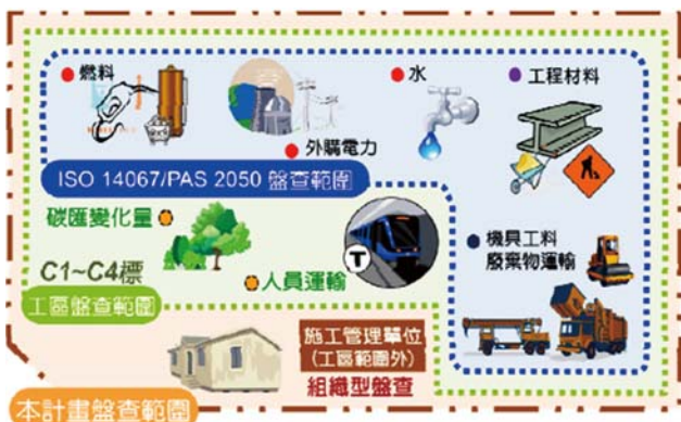
圖 3 施工階段盤查標的及範圍
